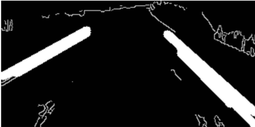
**Figura 48:** Exemplo de imagem obtida do simulador (cima) e a imagem obtida após o pré-processamento (baixo), em que as linhas artificiais correspondem às linhas brancas grossas à direita e à esquerda.
