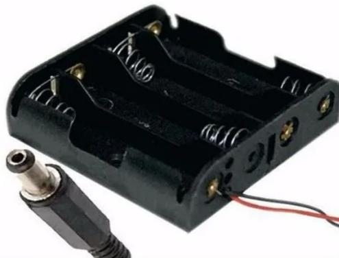
**Figura 29:** Suporte 4 pilhas AA canoa para arduino <sup>17</sup>.
