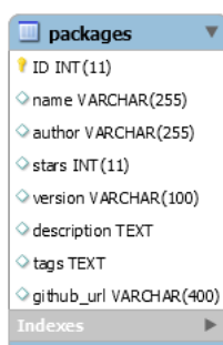
Figura 3.1: Modelo de dados para o armazenamento dos pacotes identificados no NPM.
