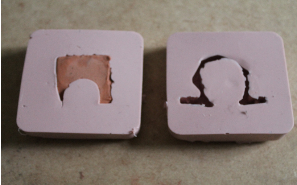
(Figura 13 – Moldes do calço para rolamento e suporte para motor)
