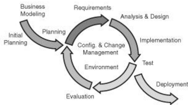
Figura 5 - Disciplinas do RUP de acordo com o fluxo do processo
